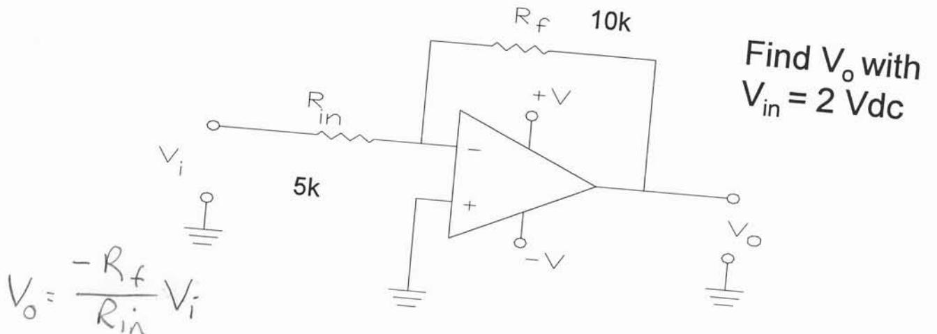
$$V_o = -\frac{10k\Omega}{5k\Omega} V_i \rightarrow V_o = -2V_i \quad V_o = -2(2 \text{ V}) = \underline{\underline{-4 \text{ Vdc}}} \text{ ANS}$$
